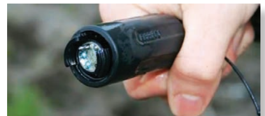
Рис. 5. Очистка разьема Expanded Beam от грязи
